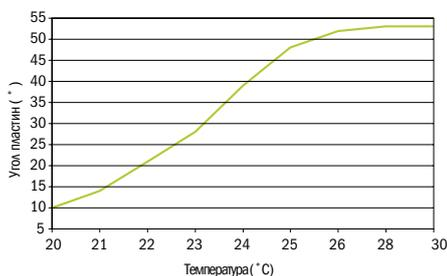
Изображение угла пластин при разных температурах приточного воздуха
