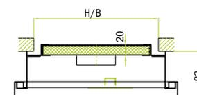
б) Непосредственная установка на воздуховоде из листовой стали, обозначение LM-2
