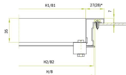
• **Крепление к стене или воздуховоду с помощью прикрепленной винтами встроенной рамы и видимого винтового соединения.**
