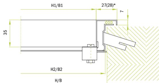
• **Крепление к стене с помощью встроенной рамы и видимого винтового соединения.**
