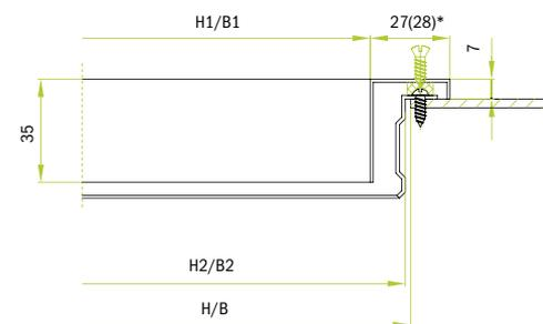
• **Непосредственное крепление к стене или воздуховоду с помощью видимого винтового соединения.**
