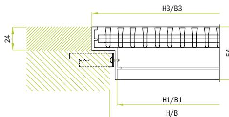
• **Непосредственное крепление к круглым воздуховодам решеток SK-2, 3, 4, 9 с помощью видимого винтового соединения.**
