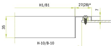
• **Крепление напольных решеток с помощью встроенной опорной рамы.**
