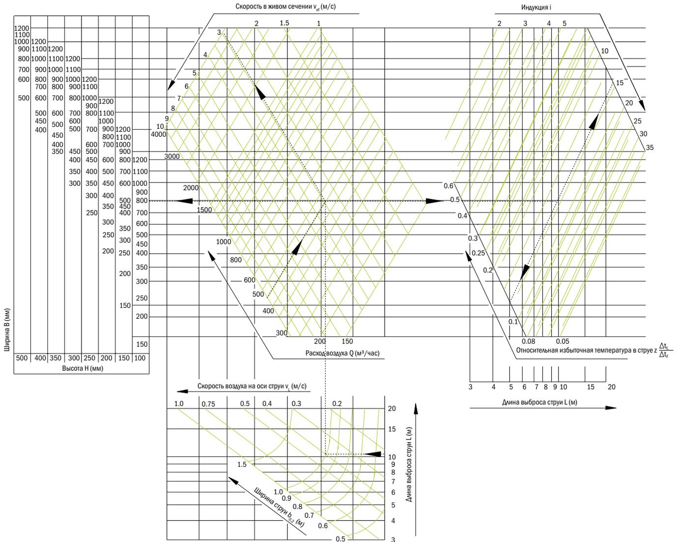
Таблица для определения поправочных коэффициентов при расположении пластин решетки под углом
