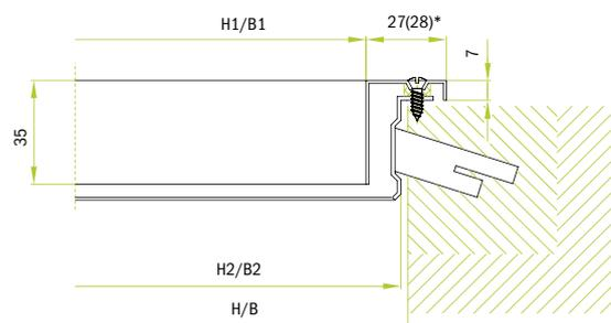
• **Крепление к стене или воздуховоду с помощью прикрепленной винтами встроенной рамы и скрытого фиксатора (замка).**
