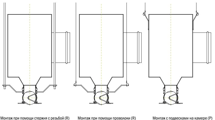
Монтаж при помощи стержня с резьбой (R)      Монтаж при помощи проволоки (R)      Монтаж с подвесками на камере (P)
