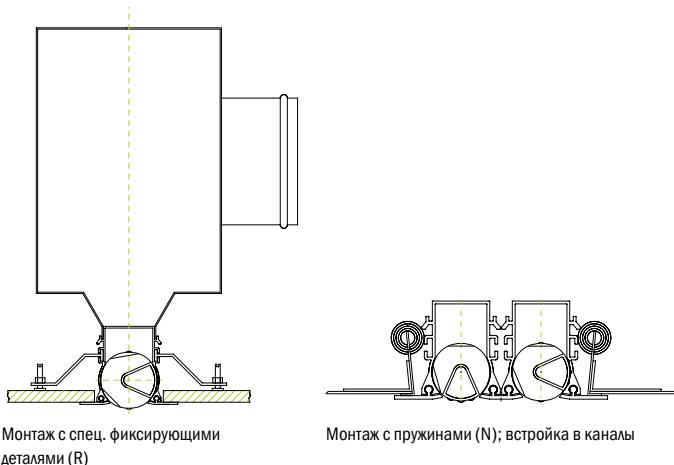
Монтаж с спец. фиксирующими деталями (R)      Монтаж с пружинами (N); встройка в каналы
