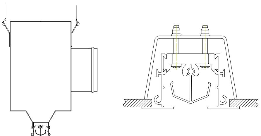
Монтаж присоединительной камеры с помощью подвесов (P)
