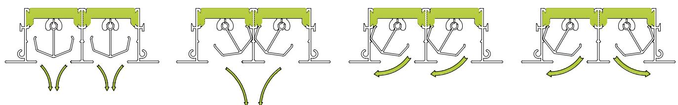
Различные настройки диффузора с двумя прорезями (в случае более двух прорезей возможны комбинации на той же основе).
